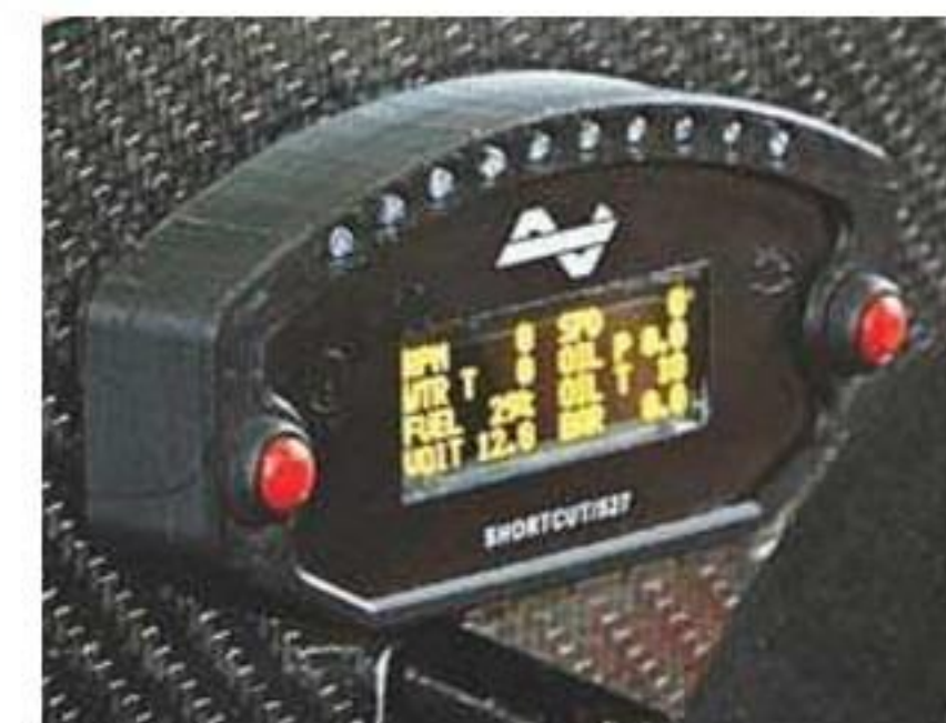
↑ Корпус панели приборов изготавливают самостоятельно на 3D-принтере. ← Салон? Скорее кокпит. На передней панели минимум приборов.
