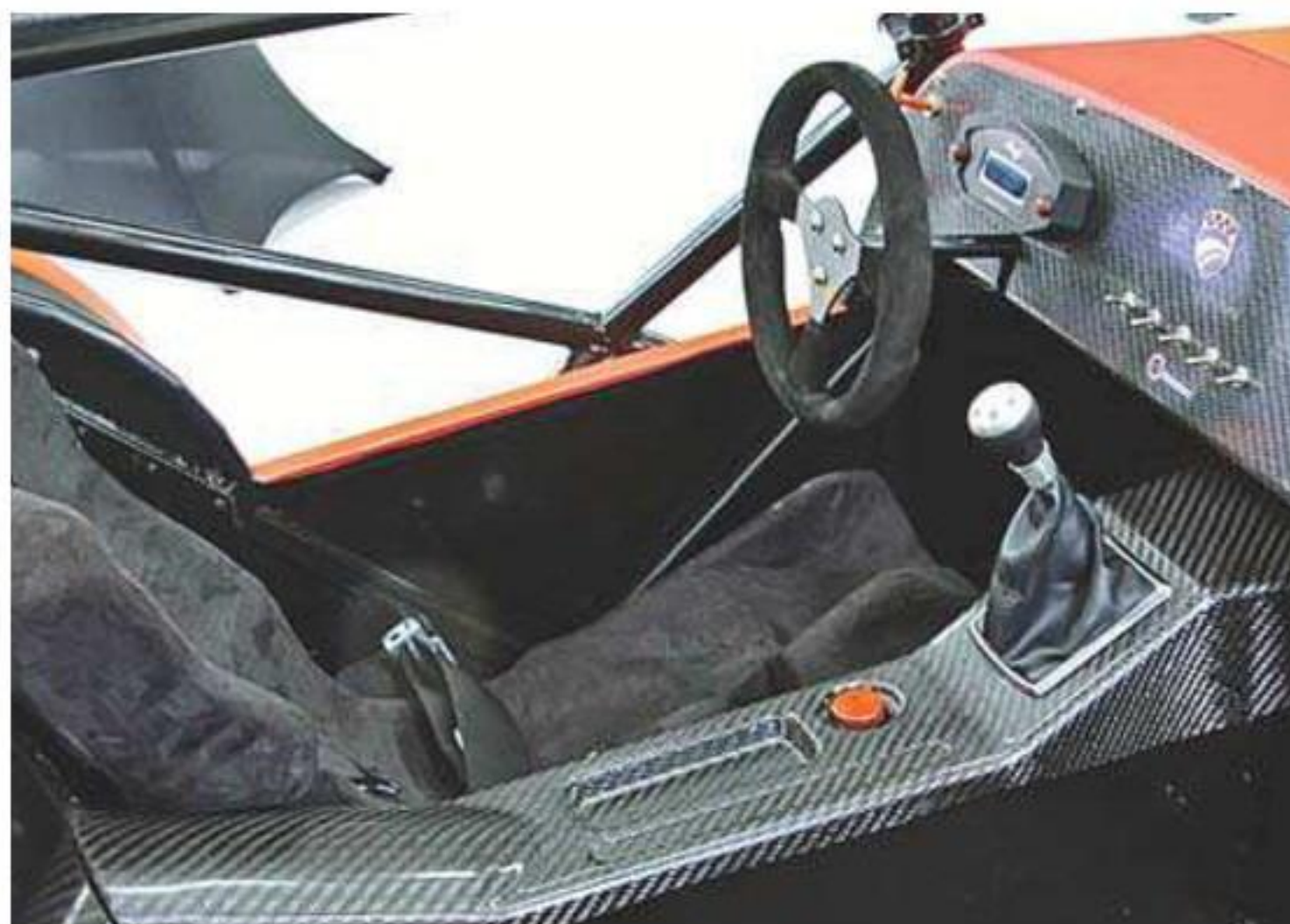
↑ Корпус панели приборов изготавливают самостоятельно на 3D-принтере. ← Салон? Скорее кокпит. На передней панели минимум приборов.
