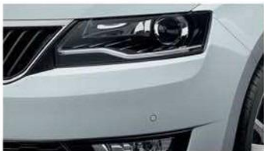
Биксеноновые фары с автоматическим управлением дальним светом
