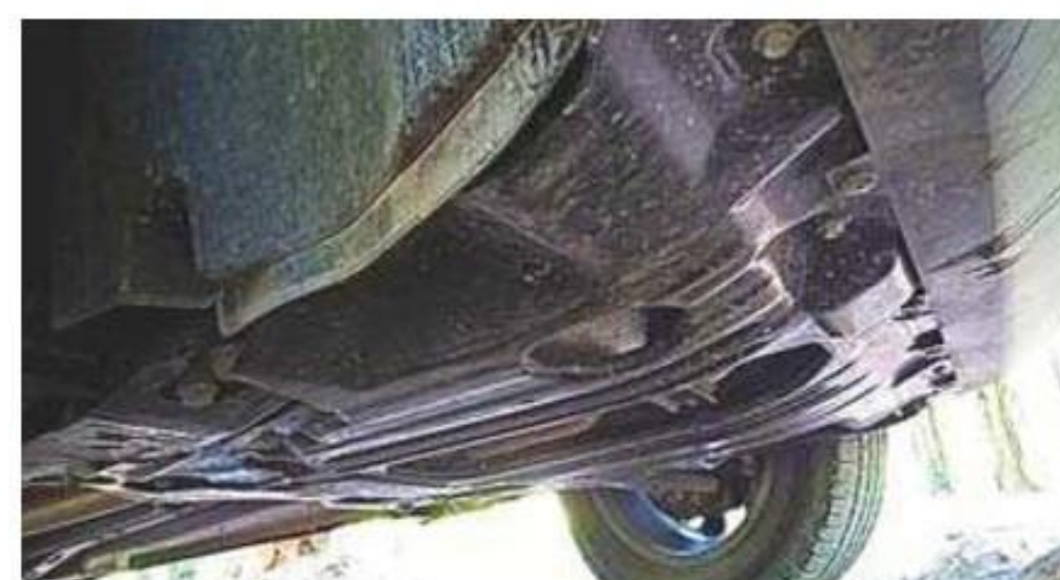
Расширенная защита днища – еще одно выгодное отличие Трейлхока.
