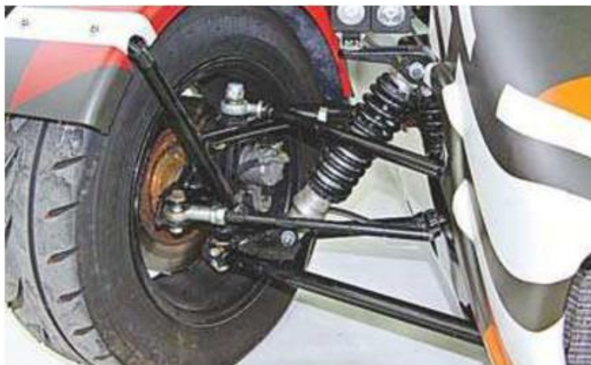
Передняя подвеска – на двойных треугольных рычагах, с регулируемыми амортизаторами. Используются гоночные шарнирные соединения – шазски.
