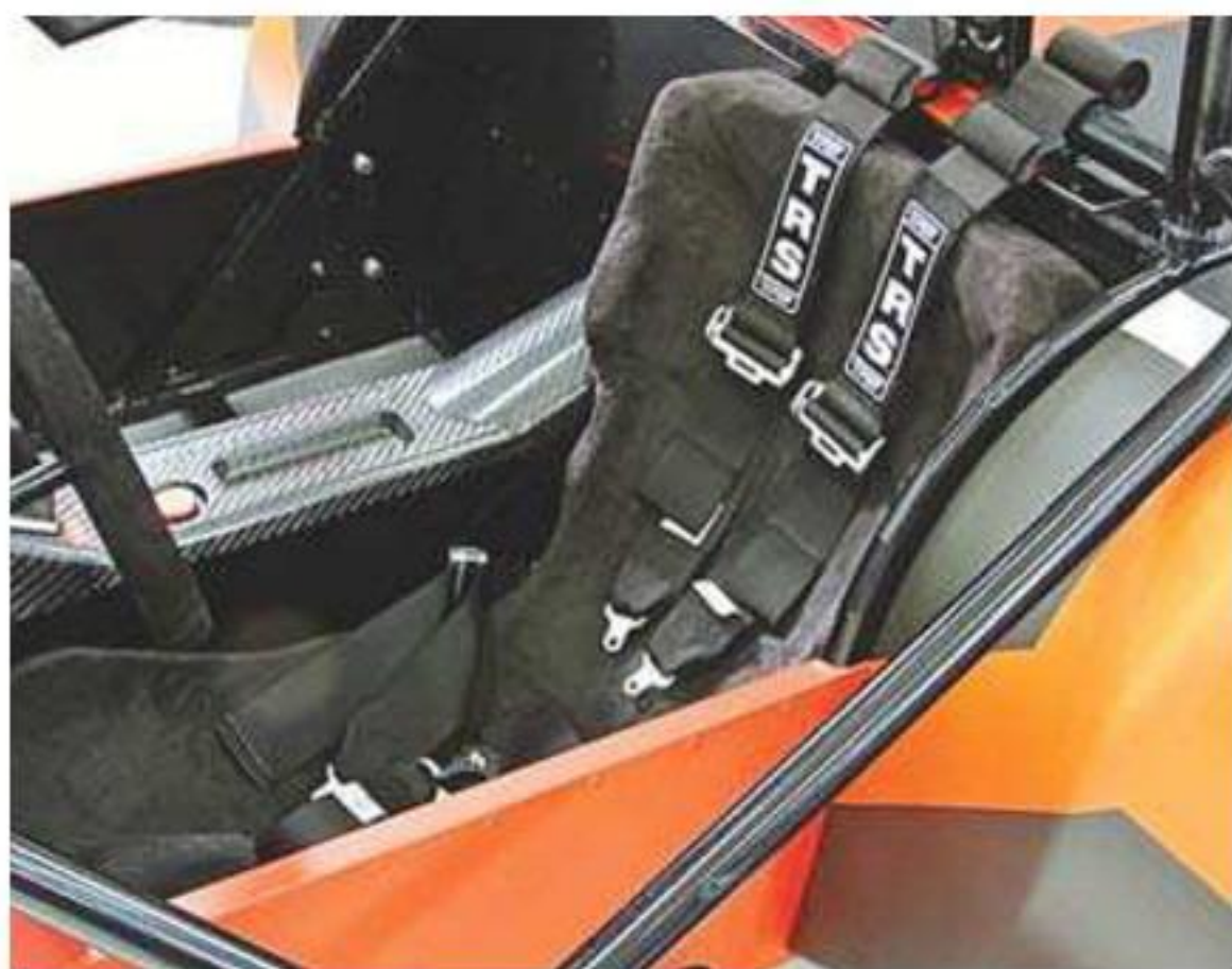
Сиденье – ложемент собственной конструкции. Можно установить и пассажирское.
