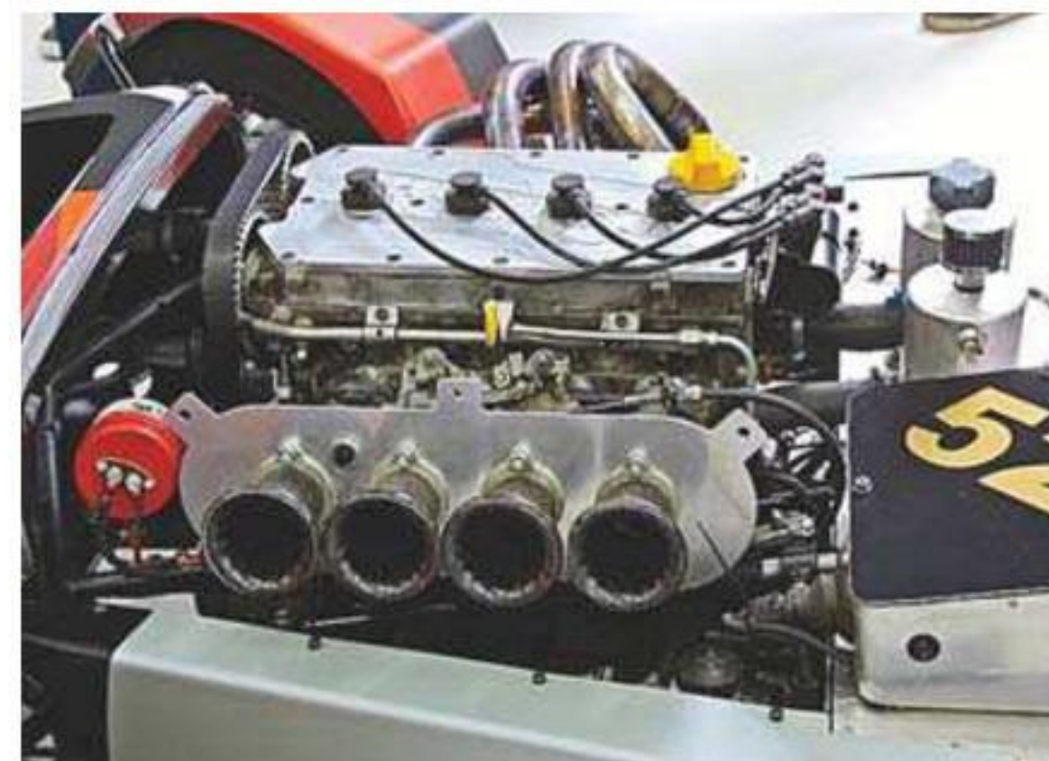
Двигатель ВАЗ-21126. Блок и головка стандартные. Изменены впуск, выпуск и программа управления. Отдача – 184 л.с.
